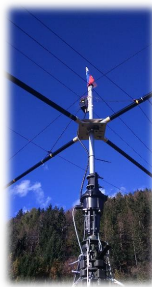
Levo spiderbeam, spredaj zgornja fazirana in v ozadju tavisok stolp za dipole in vertikalko
