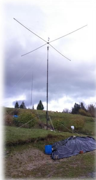
Levo spiderbeam, spredaj zgornja fazirana in v ozadju tavisok stolp za dipole in vertikalko
